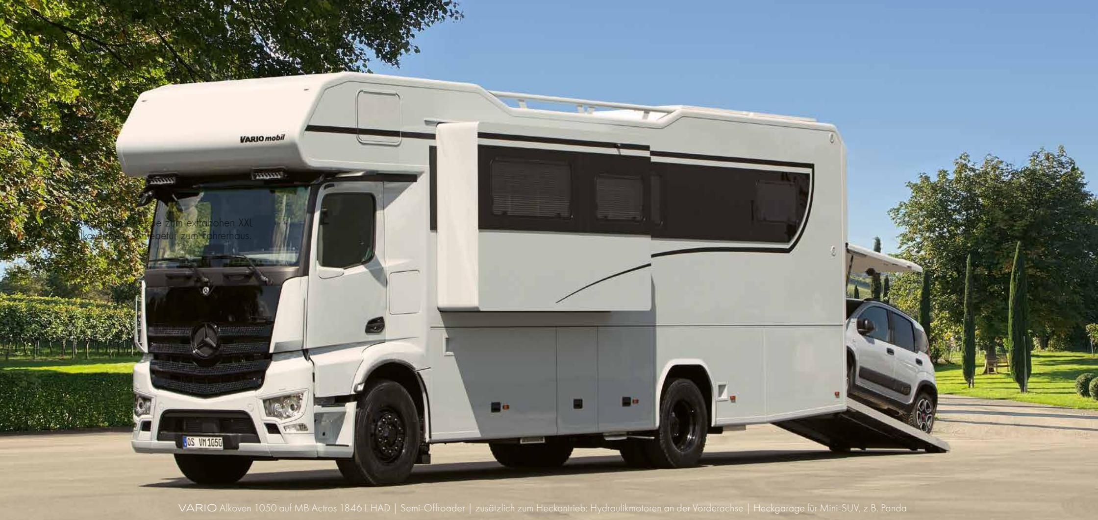
VARIO Alkoven 1050 auf MB Actros 1846 LHAD | Semi-Offroader | zusätzlich zum Heckantrieb: Hydraulikmotoren an der Vorderachse | Heckgarage für Mini-SUV, z.B. Panda
