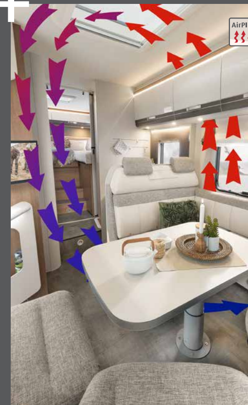
Il sistema di AirPlus previene la formazione di acqua di condensa dietro i pensili
