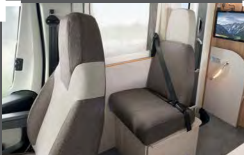
Possibilità di trasformazione della panca longitudinale nei layout DBL e EBL in un posto a sedere assicurato da cinture
