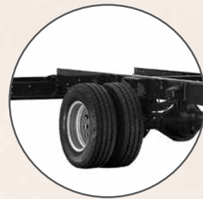
Trazione posteriore con ruote gemellate e sospensioni pneumatiche dell'asse motore
