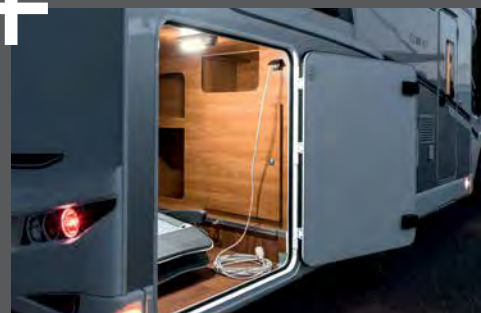
Luce e presa da 230 V nel garage posteriore
