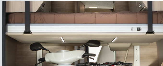
1 - LETTO BASCULANTE A MOVIMENTAZIONE ELETTRICA CON CINGHIE CHE SI FERMA ALL'ALTEZZA CHE VUOI.
