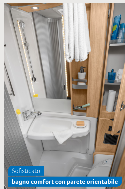
SKY TI 650 MEG. Con un solo gesto la parete girevole può essere spostata insieme al lavabo verso il WC. Così si ottiene una cabina doccia spaziosa con la massima efficienza di utilizzo dello spazio.
