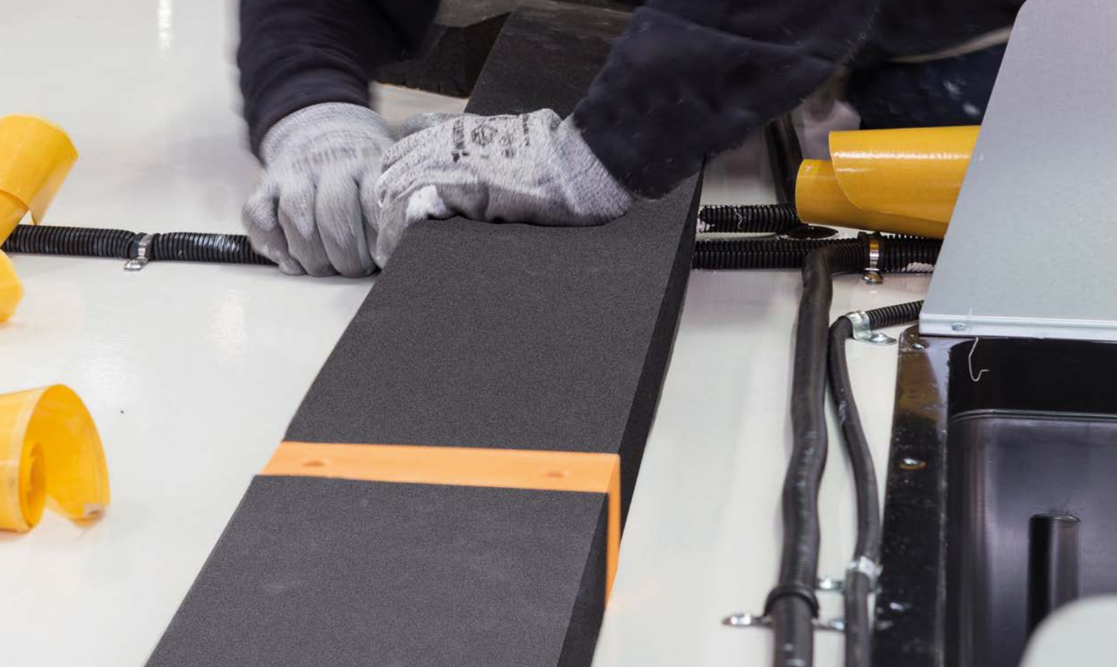
Un distanziale in materiale plastico separa il pavimento inferiore dal longherone dello chassis.
