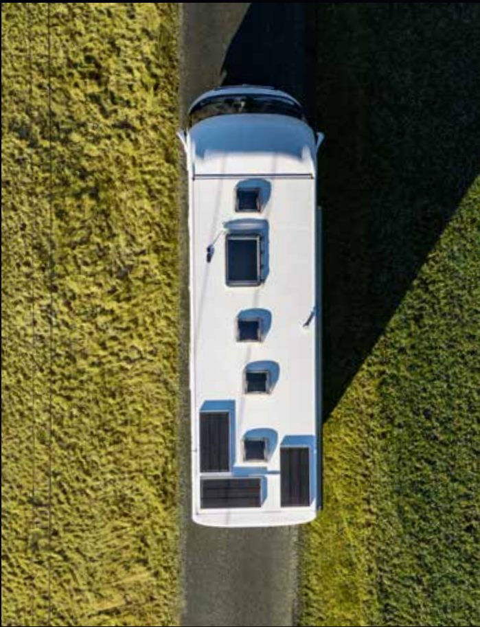
FINAL EDITION steht für Autarkie in Serie – z. B. durch 3 x 110-W-Solarmodul
