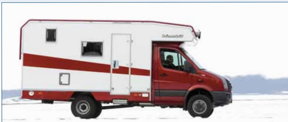
Das Reisemobil EX 400 kann mit einer Wechsellösung ausgestattet werden, die das einfache Auf- und Absetzen der Wohnkabine ermöglicht.
