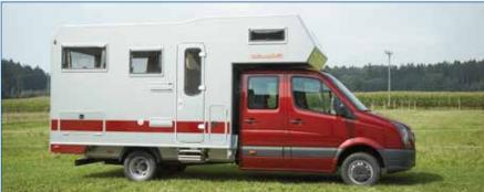
Das Modell LB 365 für MB Sprinter gibt es mit Einfach- wie auch mit Doppelkabinenfahrerhaus. Und in beiden Fällen kann das Fahrzeug mit einer Wechselvorrichtung ausgestattet werden, die das einfache Aufund Absetzen der Wohnkabinen ermöglicht. Alternative Aufbauten zur Wohnkabine wie Container oder Pritsche sind möglich.
