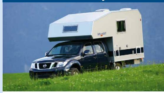
Das Modell husky 230 ist ein vollwertiges Reisemobil mit allem Komfort, aufgebaut auf einer Nissan Navara Doppelkabine, die durch Ihre vollwertige 2. Sitzreihe hinter dem Fahrer- und Beifahrersitz bequem Platz für zwei bis drei weitere Passagiere bietet. Mit dem bimobil-Wechselsystem ausgestattet, ersetzt das Basisfahrzeug so zu Hause den 5-sitzigen PKW und ermöglicht im Urlaub Ausflüge mit der ganzen Familie auch ohne Wohnkabine.
