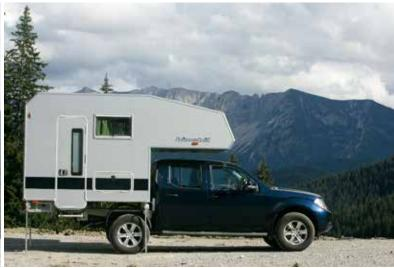
Trotz unseres Konstruktionsprinzips, die Wohnkabine direkt auf dem Fahrgestell aufzusetzen, kann die Pritsche des Originalfahrzeugs alternativ zur Wohnkabine weiter benutzt werden. Mit der zur Wechselpritsche umgerüsteten Originalpritsche wird im Handumdrehen aus dem Fahrgestell wieder ein vollwertiger Pritschenwagen.
