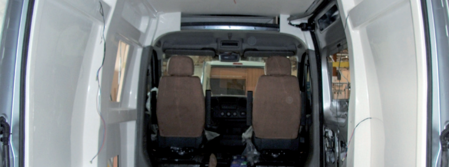
GEFORMTE INNENWAND AUS POLYESTER PARED AMOLDADA A LA CARROCERÍA / PARETE STAMPATA SULLA CARROZZERIA
