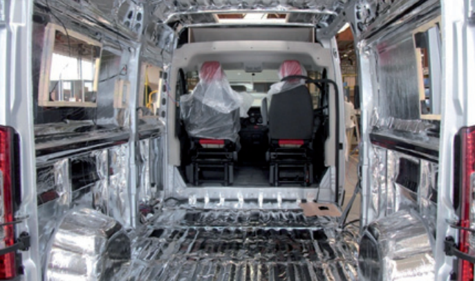
VOLLSTÄNDIGE ISOLATION XHP AISLAMIENTO TOTAL XHP / COMPLETO ISOLAMENTO XHP
