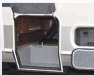
Maxi gavone incassato nel pavimento a sinistra
