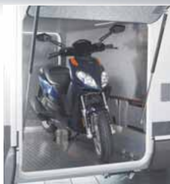
Garage posteriore fortemente abbassato, con isolamento su tutti i lati con 2 grandi sportelloni esterni, rotaie fissaggio carico con anelli posizionabili secondo necessità.
