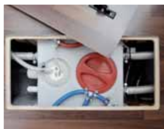
Serbatoi nel doppio pavimento
