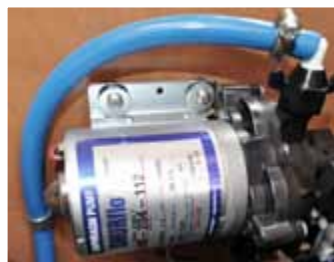
Pompa acqua a pressostato
