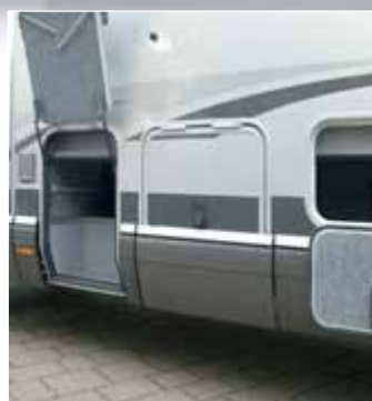
Ulteriori gavoni integrati nel doppio pavimento, riscaldati contro il gelo, isolati su tutti i lati.
