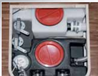
• Valvole scarico serbatoi
