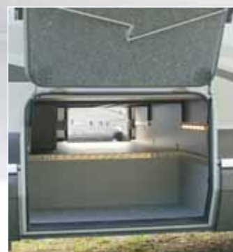
Grande gavone passante nel doppio pavimento sotto il salotto con con abbassamento sotto il pavimento e grandi sportelli esterni isolati. Gavone sotto botola nel pavimento.
