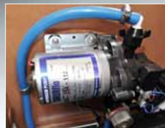
Pompa a pressostato
