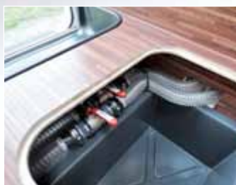
Valvole scarico serbatoi
