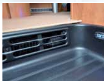
Gradino di ingresso riscaldato
