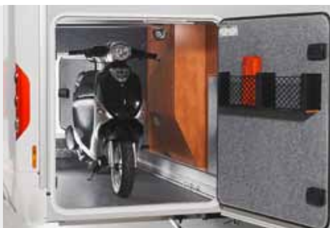
Garage per scooter: accesso attraverso due porte, altezza interna cospicua grazie al telaio ribassato, interamente isolato e riscaldato
