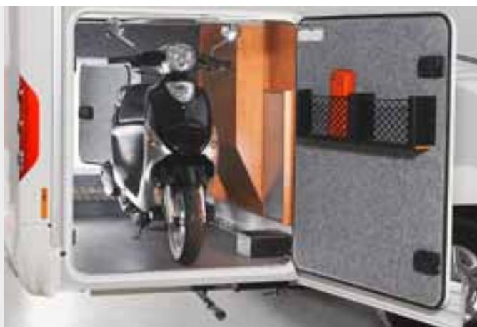
Garage per scooter: accesso attraverso due porte, altezza interna cospicua grazie al telaio ribassato, interamente isolato e riscaldato
