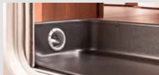
Riscaldamento mirato dei gradini di salita
