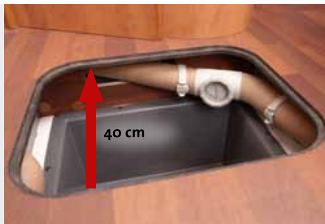
Box di stivaggio nel doppio pavimento: accesso dall'interno attraverso lo sportello nel pavimento dell'abitacolo, profondità di carico utilizzabile: 40 cm (in base ai modelli)
