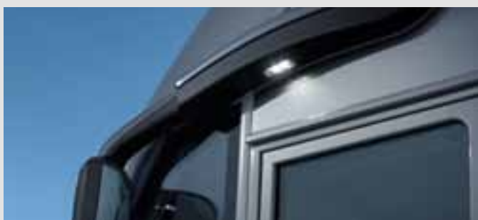
Illuminazione porta cabina "coming home"
