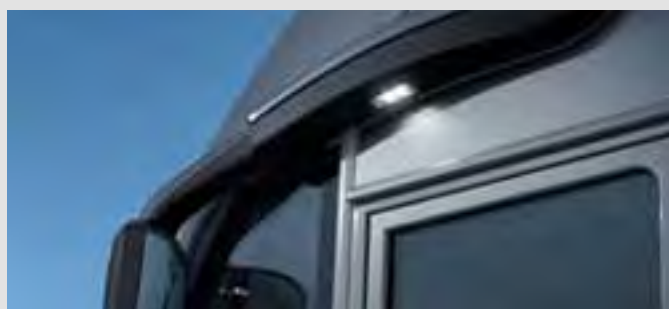
Illuminazione porta cabina "coming home"
