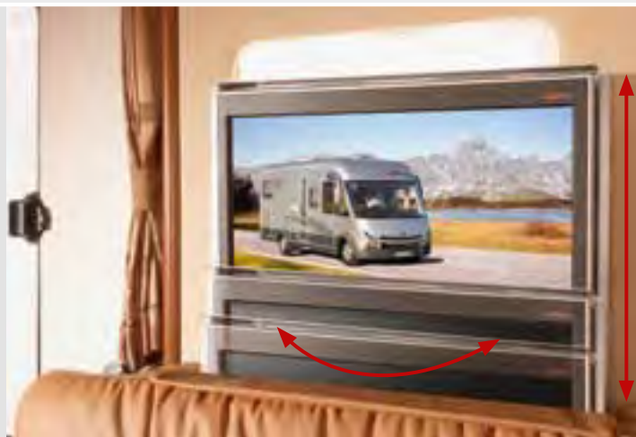
Sistema di estrazione TFT "quick-up" dietro lo schienale
