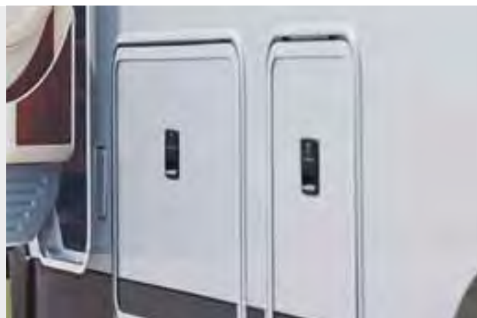
Sportelli esterni con cerniere incassate, doppie guarnizioni, guarnizione esterna antispruzzo
