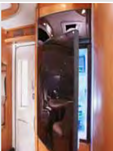
Frigorifero da 160 l posizionato in alto nell'armadio combinato separato
