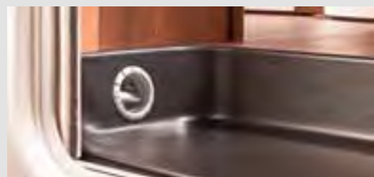
Riscaldamento mirato del gradino di salita
