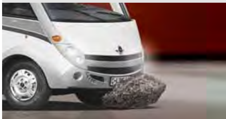
Paraurti anteriore segmentato = sostituibile
