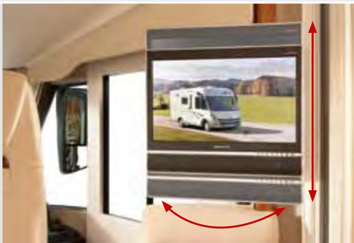
Sistema di estrazione TFT "quick up" modelli 3.8/4.3 nel sideboard della cabina
