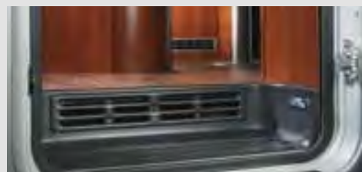
Riscaldamento scalino d'ingresso
