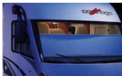
Funzione di protezione della privacy: azionamento dell'oscurante plissettato dal basso verso l'alto a veicolo fermo. Protegge da sguardi indiscreti, ma lascia tuttavia passare la luce del giorno nel veicolo.
