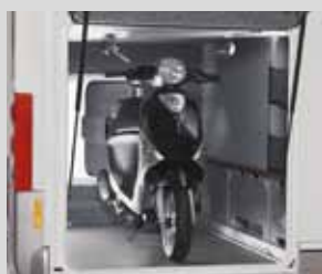
Garage per scooter con altezza interna cospicua grazie al telaio basso.
