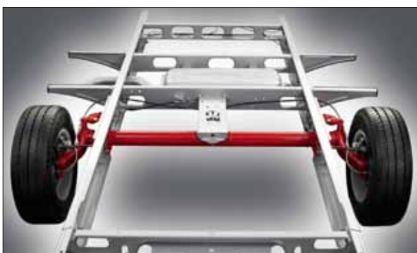
Assale posteriore con carreggiata super allargata
