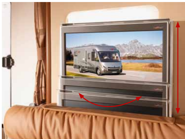
Piastra estraibile TFT "Quick-up" dietro lo schienale della panca laterale
