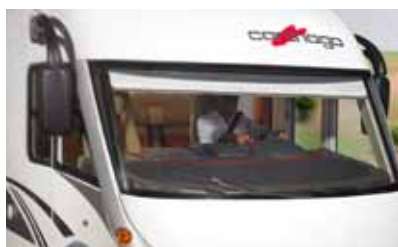
Funzione parasole: azionamento dell'oscurante plissettato dall'alto verso il basso durante la marcia.
