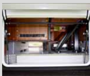
Vani di stivaggio nel doppio pavimento con sportello esterno grande.
