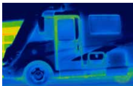
Concetto di isolamento della cabina
