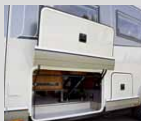
Sportelli extra grandi, tipo autobus con tecnica a parallelogramma
