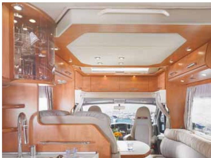
Letto basculante centrale completamente integrato nel soffitto della zona giorno, per un'altezza d'uomo completa
