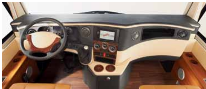
Daily: cruscotto indipendente con box freddo, paratia completamente isolata.
