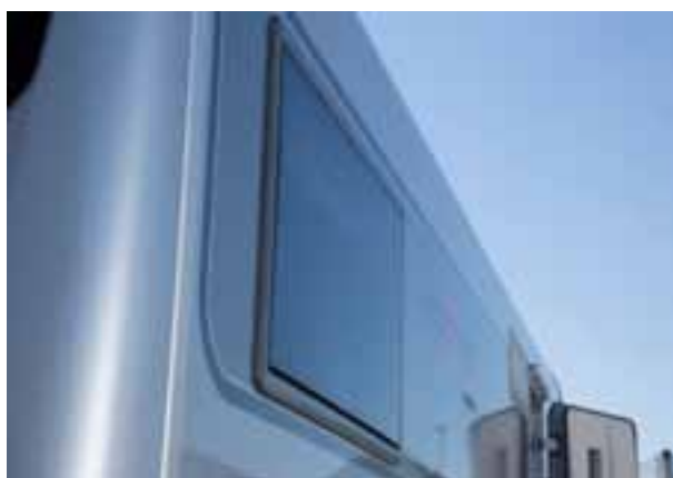
Finestre cellula Seitz de Luxe Finestre isolanti con telaio PU senza ponti termici, superficie esterna liscia
