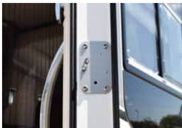
Porta cellula di sicurezza con tripla chiusura, cerniere interne in acciaio, finestrino con zanzariera
