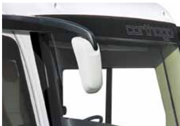
Specchi retrovisori tipo bus Liner con grande specchietto principale e specchio grandangolo
