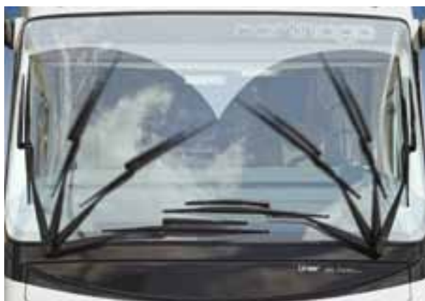
Impianto tergicristallo tipo bus con tergicristalli doppi = visibilità perfetta dello specchietto retrovisore anche quando piove
