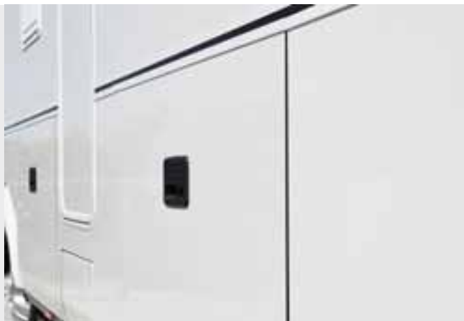
Sportelli tipo bus con apertura innovativa a parallelogramma
