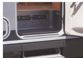
Einstiegsstufe im Doppelboden integriert, geizelt beheizt.
