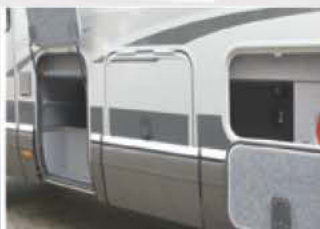
Zusätzliche Stauräume im Doppelboden integriert, frostsicher beheizt, rundum isoliert.
