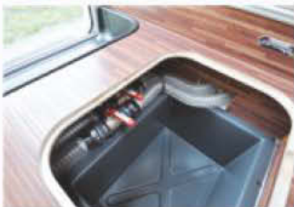
Tankablass- hähne frostsicher im beheizten Doppelboden.
