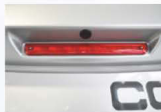
Rückfahrkamera Einfachlinse im Heckteil integriert, mit 7" Monitor seitlich im Armatu- renbrett.
