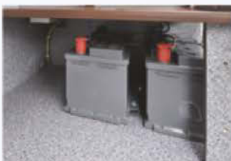
Winterfest: Batterieaufnah- me im beheizten Doppelboden, Zugang von Rollergarage.
