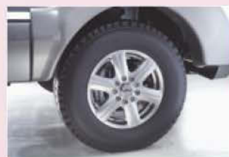
Leichtmetallfelge mit Breitreifen und Spurverbreiterung Vorderachse.
