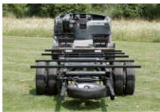
Hochrahmen Chassis Iveco Daily 65C / 70C mit Heckantrieb und Zwillingsbereifung, nach oben versetztes Fahrerhaus.
