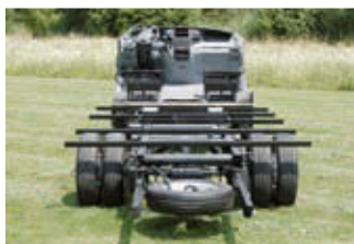
nur s-plus: Hochrahmen Chassis Iveco Daily 50C mit Heckantrieb und Zwillingsbereifung.
