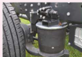
Luftfederung Hinterachse mit Funktion Heben und Senken.
