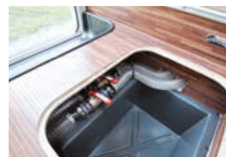
Ablasshähne im Doppelboden nach Einstieg frostsicher beheizt, Bedienung von außen möglich.
