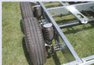
AL-KO Air Premium Luftfeder- system. Manuell regelbares, wartungsfreies Luftfederungs- system für konstante, bela- dungsunabhängige Hinter- achs-Niveaulage. Erhöhte Wankstabilität und verbesser- ter Federungskomfort.
