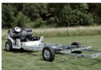
AL-KO Tiefrahmen Chassis Spezial Carthago mit Breitspurfahrwerk 1980mm.
