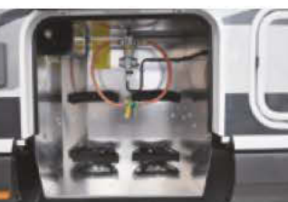
Gaskasten tief abgesenkt, bequem zugänglich für 2 x 11 kg Flaschen.
