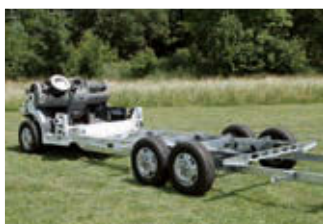
AL-KO Tiefrahmen Chassis Doppelachse, Breitspur und Heckabsenkung.
