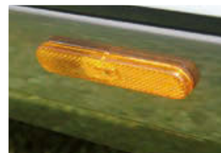
Seitenmarkierungsleuchten mit LED Lichttechnik.
