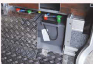
Batteriefach im beheizten Doppelboden von Rollergarage zugänglich.
