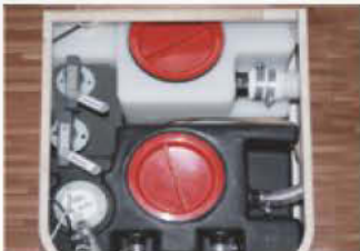
Tankablass-Hähne im beheizten Doppelboden.
