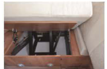
Spezialscharnier L-Sitzbank Spezialbeschläge erlauben das Öffnen ohne Entfernen des Sitzpolsters.
