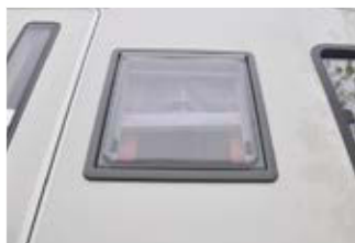
Seitz Aufbaufenster S5 kältebrückenfrei, getrennter PU-Rahmen, innenliegendes Isolationsfenster.
