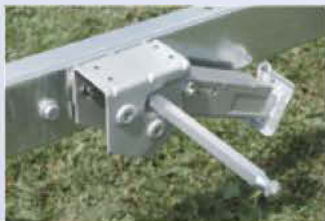
Kurbelheckstützen AL-KO zur Wankstabilisierung des Fahrzeuges im Stand.
