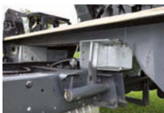
Fahrerhaus „Linerfeeling“ nach oben versetztes Original Iveco Fahrerhaus.
