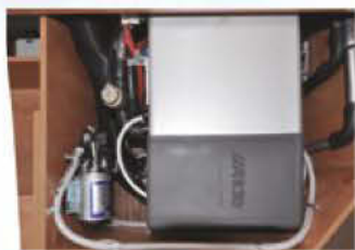
Alde Zentralheizung wartungsfreund- lich in Seitensitz- bank.
