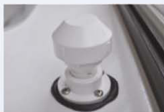
SOG-Toilettenentlüftung über Dachkamin.
