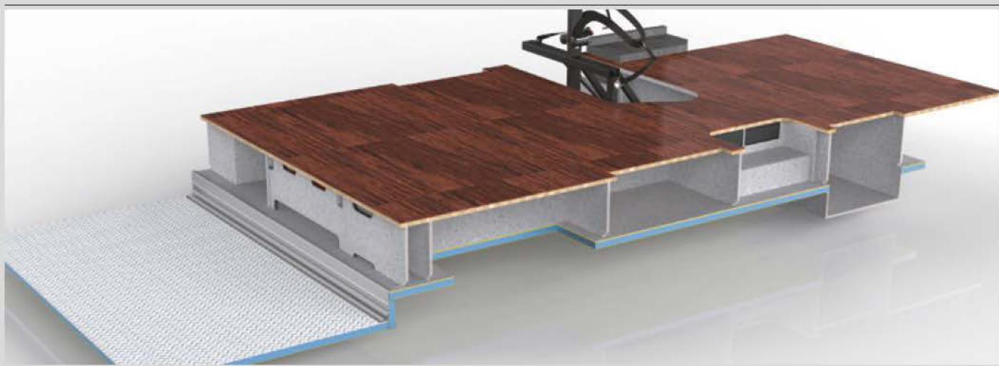
Wohnraumboden mit massiver Doppelbodenkonstruktion, Bodenplatte mit GFK Unter- und Oberseite.
