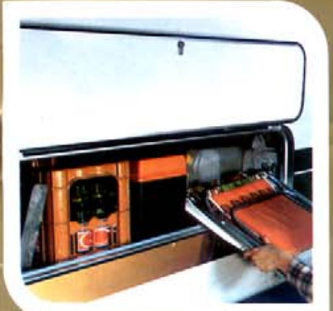
Dieser Stauraum ist ein Stau-Raum. Die Patent angemeldete Sandwichbauweise des Clou ermöglicht große Ausschnitte und zentimeterweise Anpassung ohne Verlust an Stabilität. Hier stören keine Rahmen und Verstrebungen.
