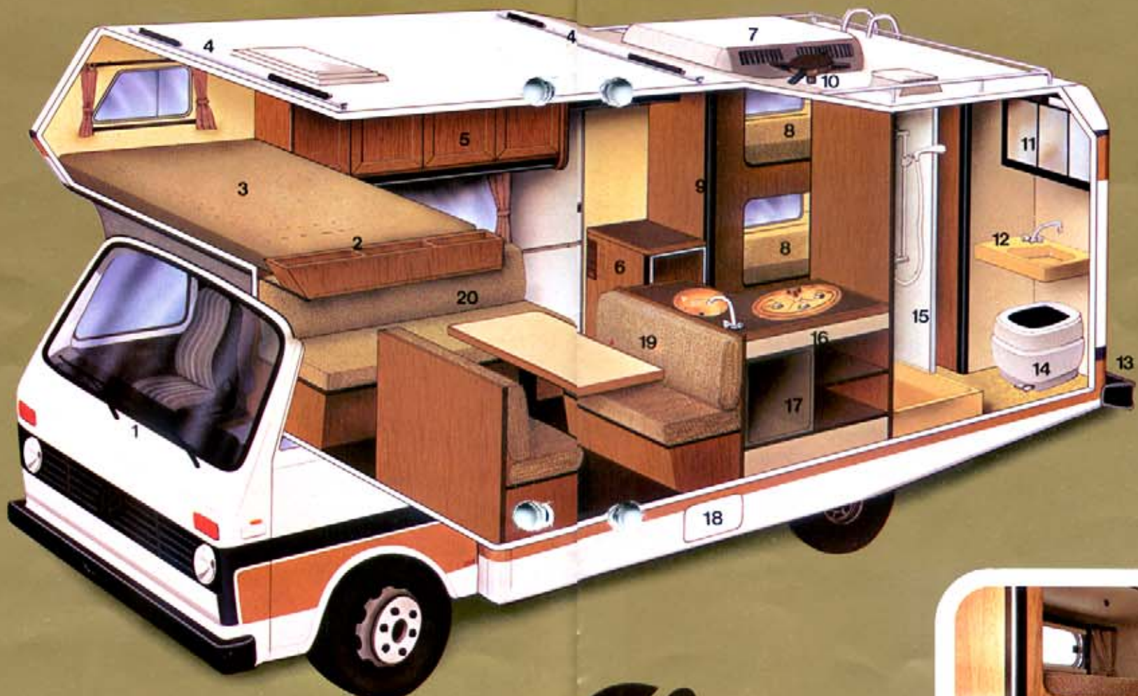
Dieser Stauraum ist ein Stau-Raum. Die Patent angemeldete Sandwichbauweise des Clou ermöglicht große Ausschnitte und zentimeterweise Anpassung ohne Verlust an Stabilität. Hier stören keine Rahmen und Verstrebungen.
