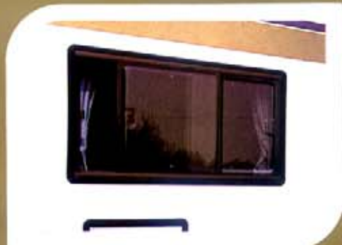
Die serienmäßigen Schiebefenster können auch während der Fahrt geöffnet werden. Der Polyurethan-Rahmen läßt keine Kältebrücke entstehen.
