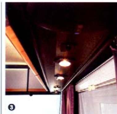
3: Exclusives Alu-Oberschrankprofil mit integrierten Leitungskanälen, Lautsprechern, Lampen und Vorhangschienen
