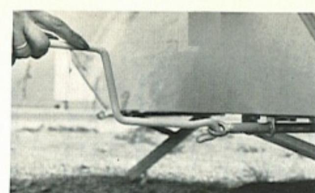
Die verzinkten Kurbelstützen münden nicht wie üblich in einem Sechskant, sondern in einer Öse. Hier kann man auch in schräger Stellung kurbeln, sogar Einhand-Bedienung ist möglich. Bei Nichtgebrauch hängt die kunststoffüberzogene Kurbel im Wageninneren neben dem Eingang.
