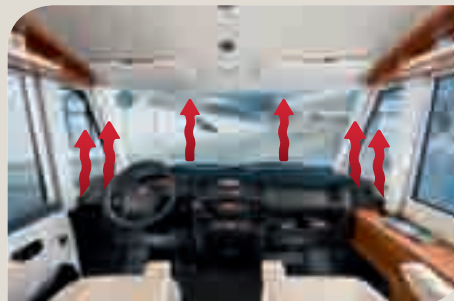
► Armaturenbrett mit innenliegendem Luftkanal für schnelle Scheibenentfrosterung (S.120)
