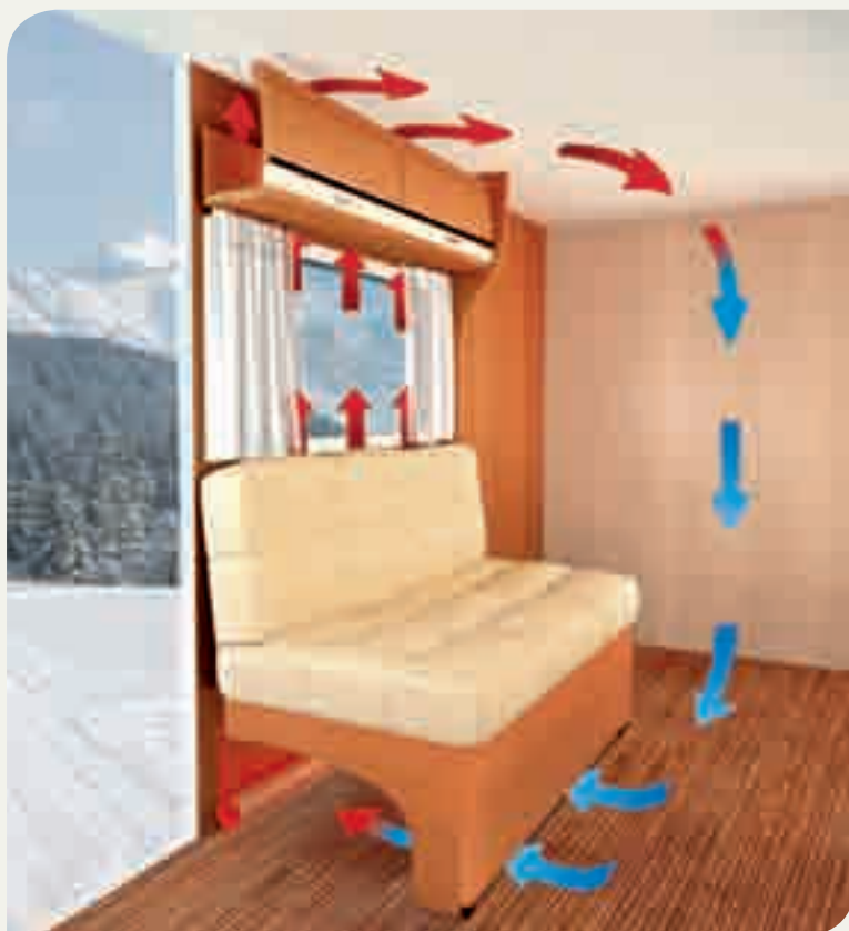
► Das AirPlus-System verhindert die Bildung von Kondenswasser
