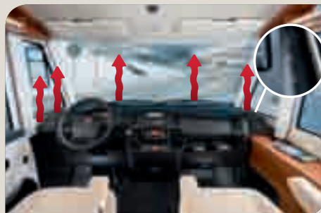
► Für schnelle Scheibenentfrosterung sorgt der Heizkanal der Aufbauheizung im Armaturenbrett
