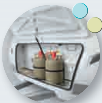
Stabil und praktisch: viel Stauraum im Gaskasten mit Riffelblechboden
