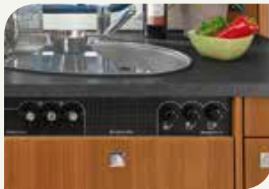
► Griffgünstig positionierte Gasabsperrventile
