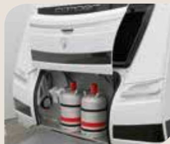
► Gaskasten mit stabilem Riffelblechboden
