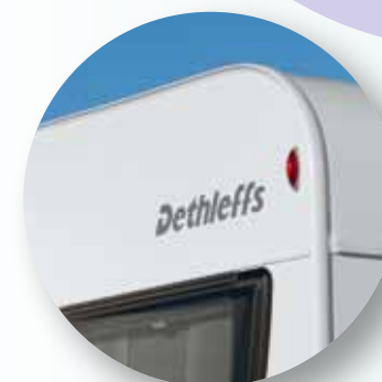
Hochwertig: breite, weiß eloxierte Kantenleiste mit Kederschiene
