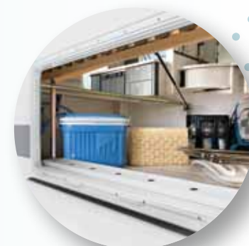
Praktisches Stauraumfach mit Außenklappe. Bei hochgeklapptem Bett auch von innen erreichbar.
