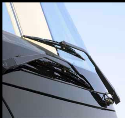
Gegenläufiges, hochstabiles Wischersystem
