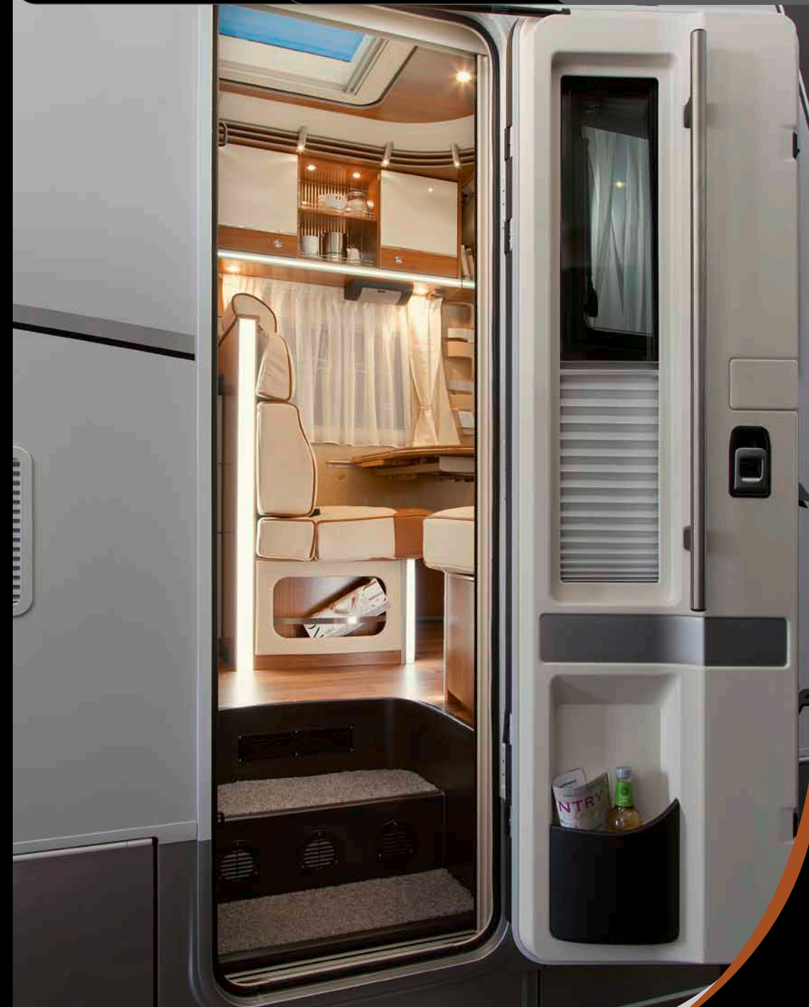
Stabile Wohnraumtür mit verdeckter 2-Punkt-Verriegelung
