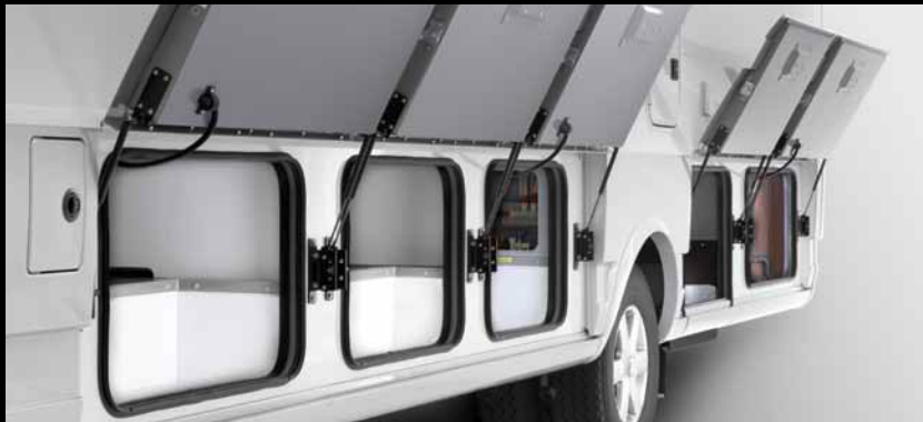
Reisebus-Stauraumklappen aus Aluminium mit großem Öffnungswinkel
