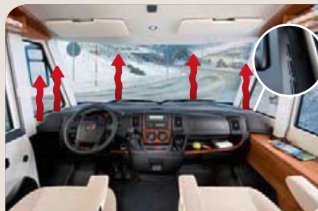
► Für schnelle Scheibenentfrostung sorgt der Heizkanal der Aufbauheizung im Armaturenbrett
