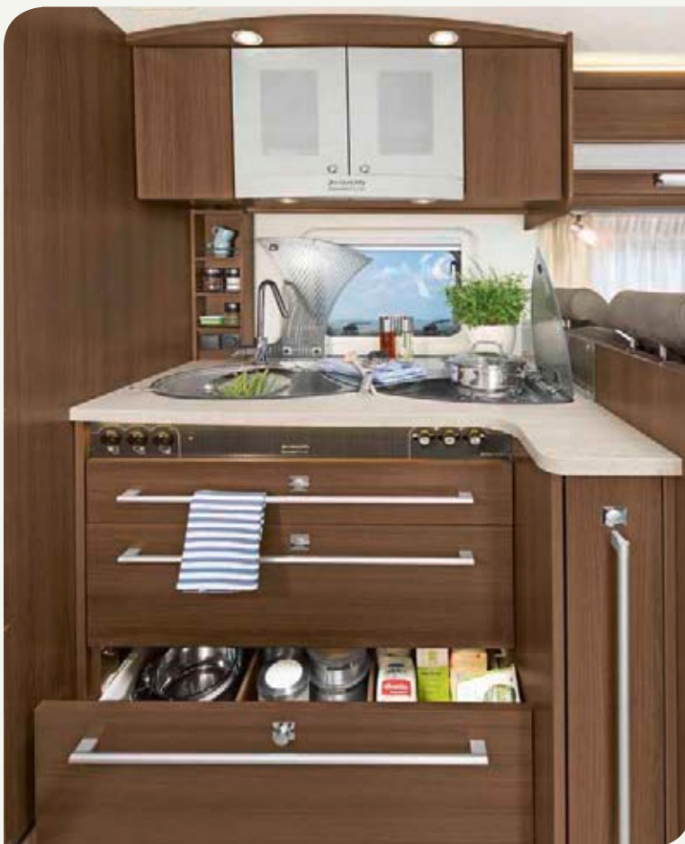
► Ein LED-Band unter der Arbeitsfläche beleuchtet die Schubladen
