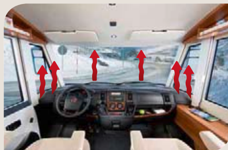
► Amateurbrett mit innenliegendem Luftkanal für schnelle Scheibenentfrosterung (S.102)
