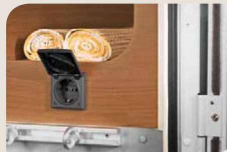
► Praktisch: 230 Volt Steckdose und verstellbare Festzurrösen in der Heckgarage
