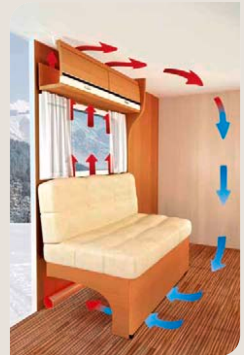
► Die Dachschrank Hinterlüftung AirPlus sorgt für ein gutes Raumklima (s. S. 104)
