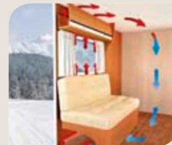
► AirPlus-System zur Hinterlüftung der Dachschränke s. S. 71
