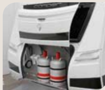
► Gaskasten mit stabilem Riffelblechboden
