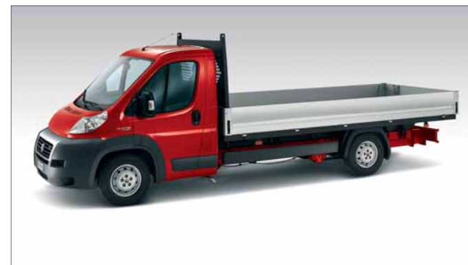
Per rispondere alla necessità di un piano di carico di grandi dimensioni, Nuovo Ducato è allestibile con cassoni super lunghi. Le sponde in alluminio alte 400 mm sono ribaltabili sui tre lati per agevolare carico e scarico delle merci.
