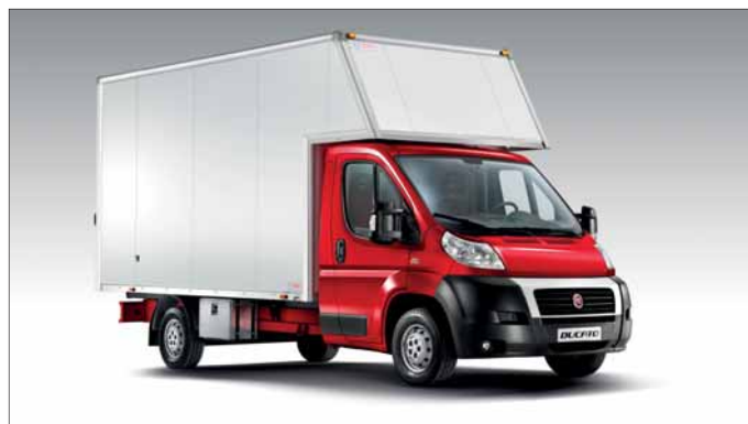
Nuovo Ducato cabinato allestito con furgonatura specifica per mobili che necessitano di molto volume, costituita da pannelli in alluminio o lisci, appoggiati su un controtelaio strutturale in alluminio saldato.
