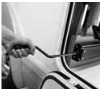
Regolazione in altezza del letto posteriore: regolazione continua idraulica dell'altezza del letto posteriore per i modello con garage (a seconda della pianta).
