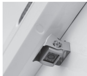
Rückfahrkamera: zum leichteren und genaueren Rückwärtsfahren; schaltet sich bei Einlegen des Rückwärtsganges automatisch ein.
