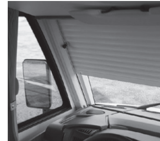
elektrischer Rollladen: für Integra Line und Integra Line LS dient auch als Sichtschutz und zusätzliche Isolierung im Fahrerhaus
