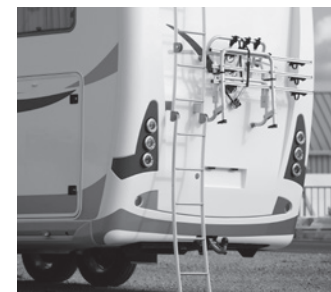
Leiter: fest montiert am Fahrzeugheck, zum leichteren Erreichen der Dachfläche
