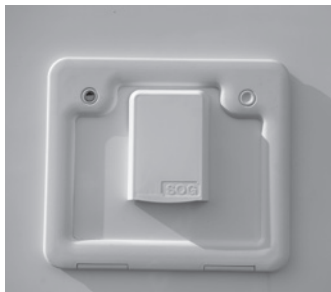
SOG: automatische Toilettenentlüftung
