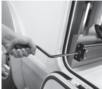
Höhenverstellung Heckbett: stufenlose, hydraulische Bettenhöhenverstellung bei Modellen mit Garage (grundrissabhängig).
