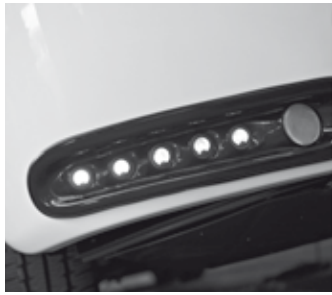
Tagfahrlicht plus Nebelscheinwerfer für Integra und Integra Style: in die Frontpartie unter den Scheinwerfern integriert
