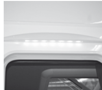
Außenbeleuchtung: zum Beleuchten des Türbereiches, z.T. mit integriertem Regenablauf.
