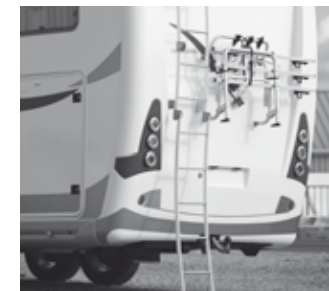
Leiter: fest montiert am Fahrzeugheck, zum leichteren Erreichen der Dachfläche
