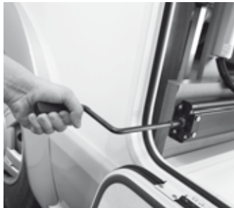
Höhenverstellung Heckbett: stufenlose, hydraulische Betthöhenverstellung bei Modellen mit Garage (grundrissabhängig).
