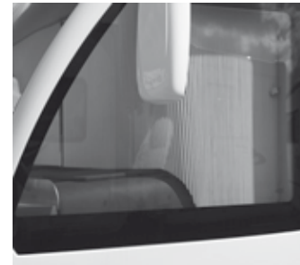
Plisseé Integra Style: Faltporhang mit Wabenstruktur als Sichtschutz und zusätzliche Isolierung im Fahrerhaus
