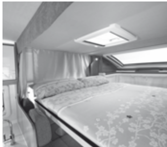
Hubbett für Teilintegrierte: elektrisch betätigtes Hubbett für bis zu zwei Personen;
