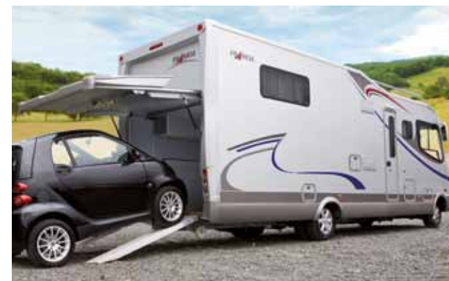
Garage vettura per telaio Iveco
