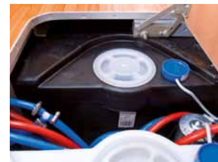
Serbatoi alloggiati nel doppio pavimento
