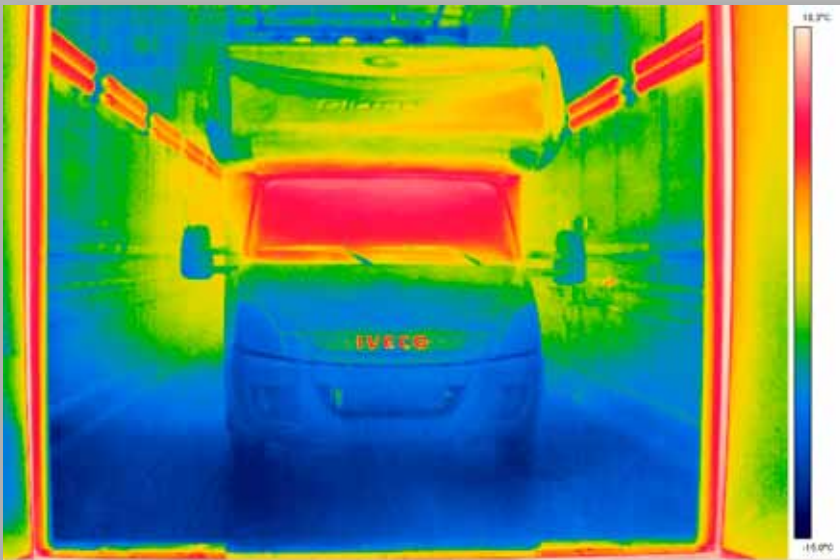
test Camera Climatica TRUMA temp. -15° C climatic chamber test TRUMA temp. -5° F essais en chambre climatique TRUMA temp. -15° C pruebas de cámara de clima TRUMA temp. -15° C
