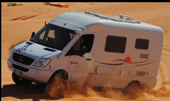
Monoscocca su meccanica Mercedes anche per 4x4 uso "estremo"
