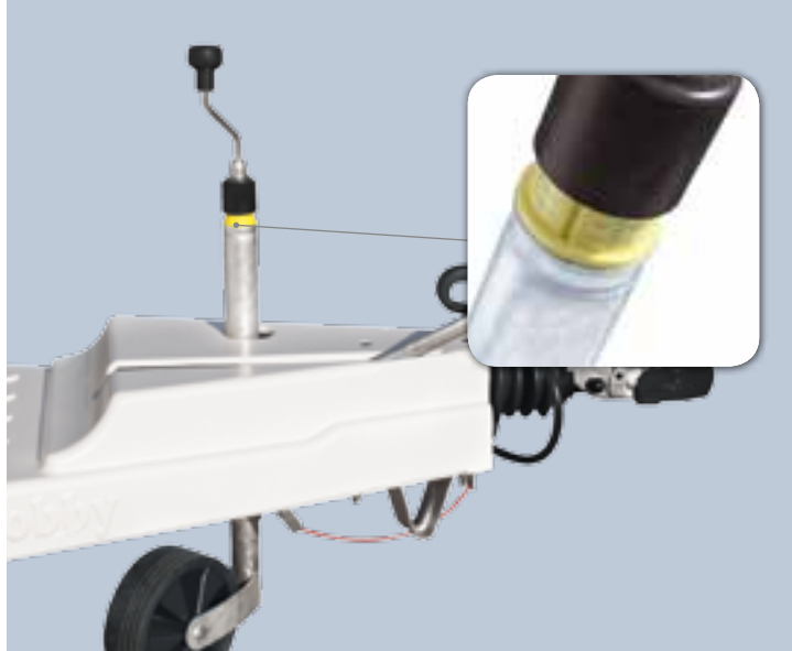
Timone con copertura ed indicatore di carico sul ruotino d'appoggio
