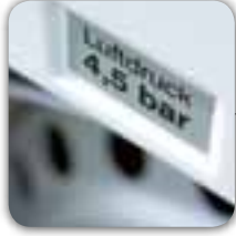
Indicazione della pressione degli pneumatici sul passaruota
