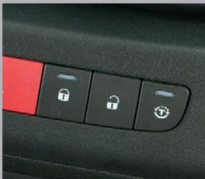
**Cabina di guida protetta:** La chiusura centralizzata, che può anche essere controllata dalla chiave di accensione, permette di aprire e chiudere la portiera del conducente premendo semplicemente un pulsante. In questo modo, nel motorcaravan parcheggiato, può essere prevenuto l'accesso non autorizzato in cabina di guida.
