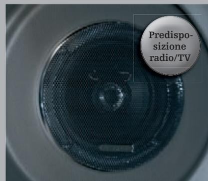
**Predisposti per radio e TV:** Gli altoparlanti nella zona abitativa ed in cabina di guida, il supporto TV, il cablaggio e la presa elettrica così come l'antenna radio sono già inseriti in ogni veicolo in uscita dalla fabbrica. Gli apparecchi radio e TV possono così essere connessi molto semplicemente ed essere utilizzati.
