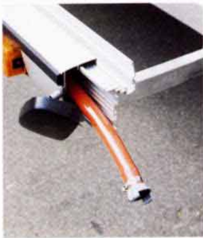
Tubo per lo scarico delle acque posto all'interno del paraurti.
