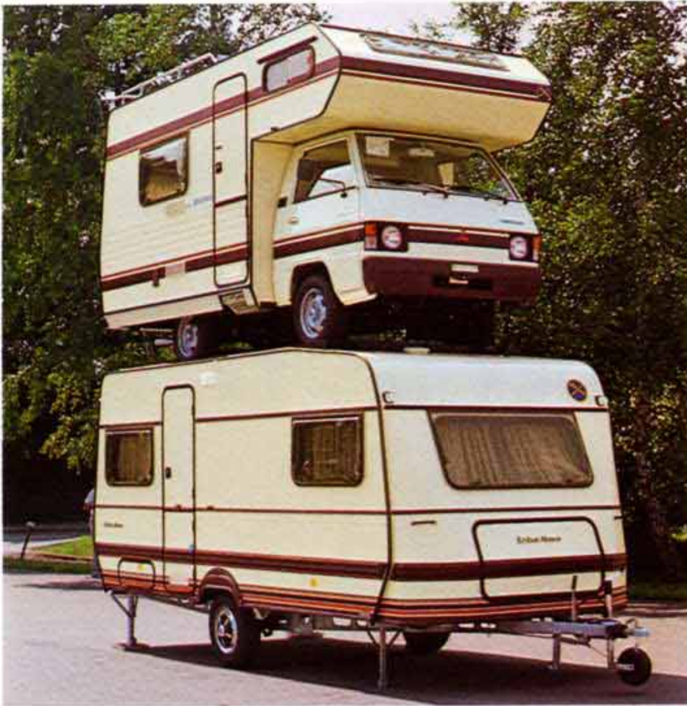
I 1720 Kg. del Hymercamp 45 sul tetto della Nova provano la stabilità del sistema PUAL.
