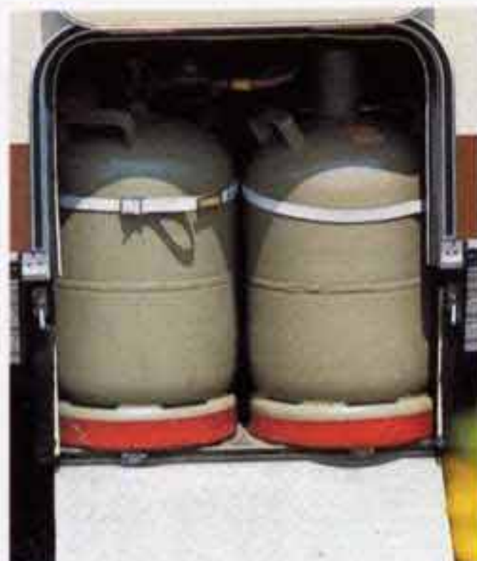
Portabombole integrato per due bombole da 11 Kg.
