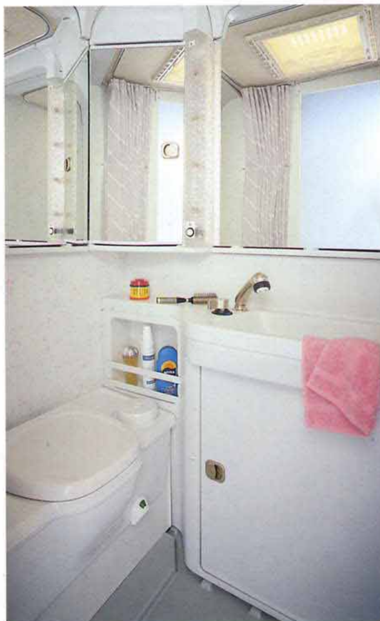
Bagno con WC ed acqua corrente, comodo scarico tramite valvola esterna.
