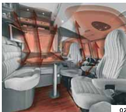
02 Zona abitativa: Bocchetta aria calda della finestra e sotto la dinette a L
