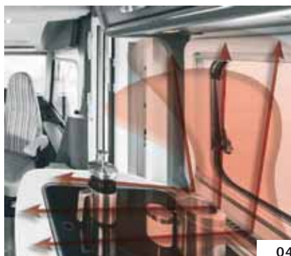
04 Cucina: Bocchetta aria calda della finestra
