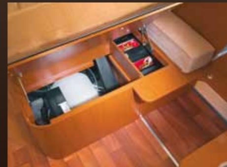
Zentral platzierte Truma Heizung (6.000 W)
