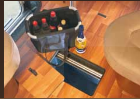
GFK-Wanne mit Stautaschen im Doppelboden
