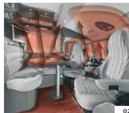
Zona abitativa: Bocchetta aria calda della finestra e sotto la dinette a L
