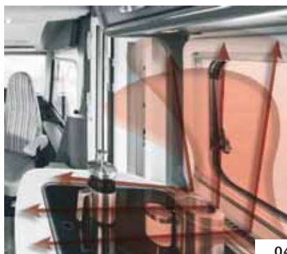
Cucina: Bocchetta aria calda della finestra
