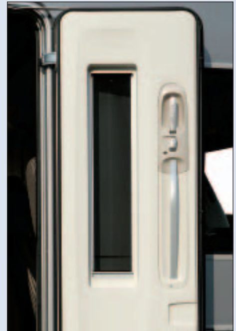
Eingangstür Tramp SL. Gilt aufgrund ihrer 3-fach-Verriegelung und verdeckter Scharniere als extrem einbruchsicher. Darüber hinaus sieht sie auch noch „chic“ aus.
