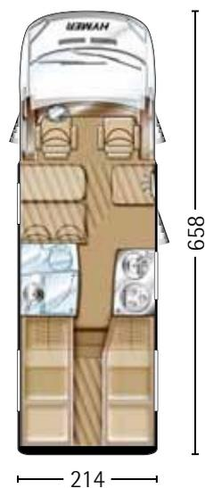
HYMER Van 562 si distingue per la camera da letto con i letti singoli longitudinali. Letti facilmente accessibili tramite gradini, con consolle notturna nel mezzo, con raffinati dettagli come l'armadio sotto il piano del letto singolo di sinistra e come il gavone con estensioni sotto il piano del letto singolo di destra.
