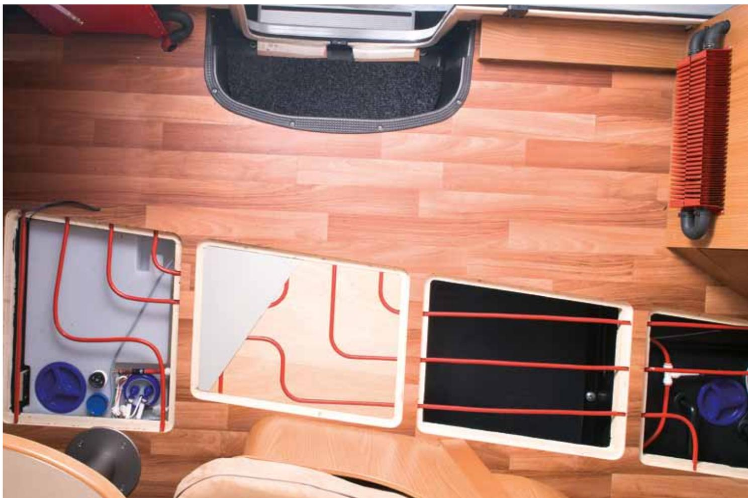
*Progettazione del pavimento e del riscaldamento
