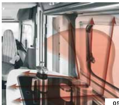
Cucina: Bocchetta aria calda della finestra
