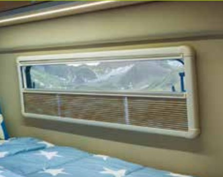
La maggiore sicurezza contro gli scassi e la migliorata protezione dal freddo invernale sono ottenute grazie al pregiato telaio in alluminio delle finestre; sono compresi plissé oscuranti e zanzariere.
