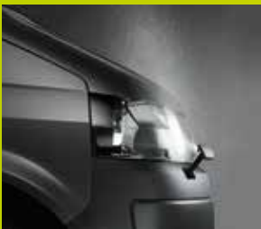
Impianto di pulizia fari con ugelli riscaldabili (2586)
