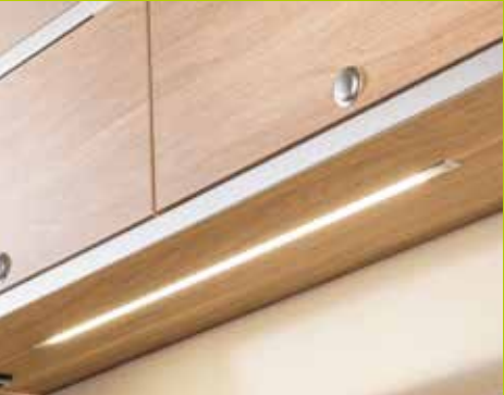
Negli HYMERCAR montiamo solo lampade a LED a basso consumo. Sono sostituite persino le lampadine originali fabbricate in serie dal produttore del telaio. Con la batteria da 95 Ah avete fino a 4 giorni di autonomia.
