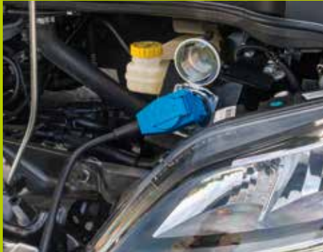
L'allacciamento elettrico si trova nel vano motore, onde escludere potenziali fonti di pericolo per via di punti anermetici.
