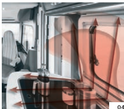
04 Cucina: Bocchetta aria calda della finestra
