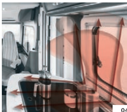
Cucina: Bocchetta aria calda della finestra
