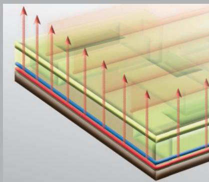
**Installazione protetta dal gelo:** Tutti gli impianti idrici del motorcaravan sono installati in zone riscaldate e per questo certamente protetti dai possibili danni dal gelo. Il serbatoio dell'acqua dolce ed il serbatoio delle acque grigie sono posizionati in vasche isolate nel doppio pavimento multifunzione e là vengono avvolti dall'aria calda in circolazione.
