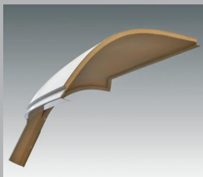
**Isolamento termico in cabina di guida:** Un ottimo isolamento, come nella zona abitativa, è presente anche davanti, nella cabina di guida. La sezione frontale, in vetroresina a doppio guscio con in mezzo uno strato a barriera termica coibentato con poliuretano espanso, garantisce sul fatto che anche nella parte anteriore del motorcaravan il freddo non è un problema.
