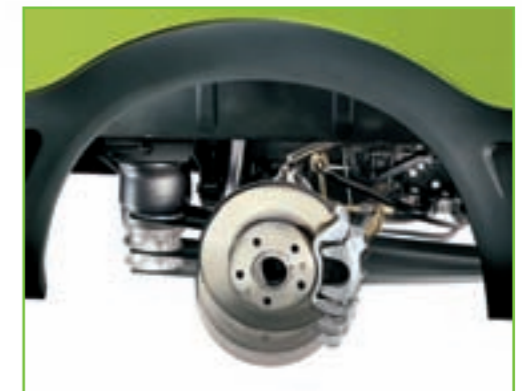
Sospensione posteriore pneumatica
