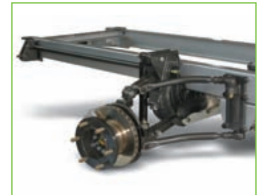
Sospensione anteriore rinforzata con barra di torsione
