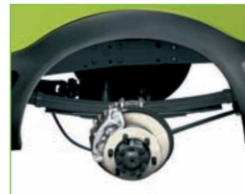
Sospensione posteriore semiellittica rinforzata
